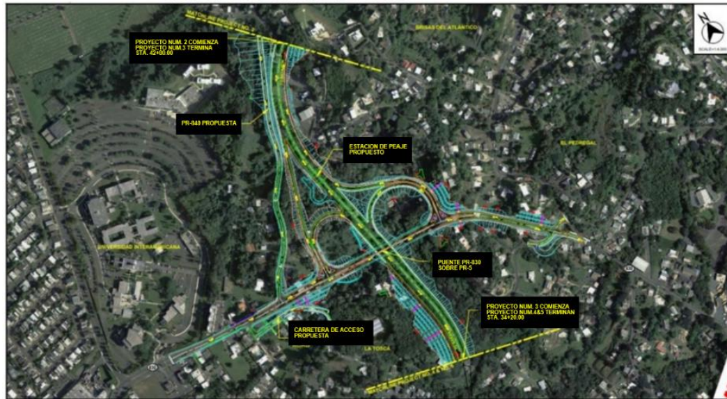
Figura 5: Proyecto 3 – Puente sobre la PR-830 (Intersección PR-830/PR-5)
