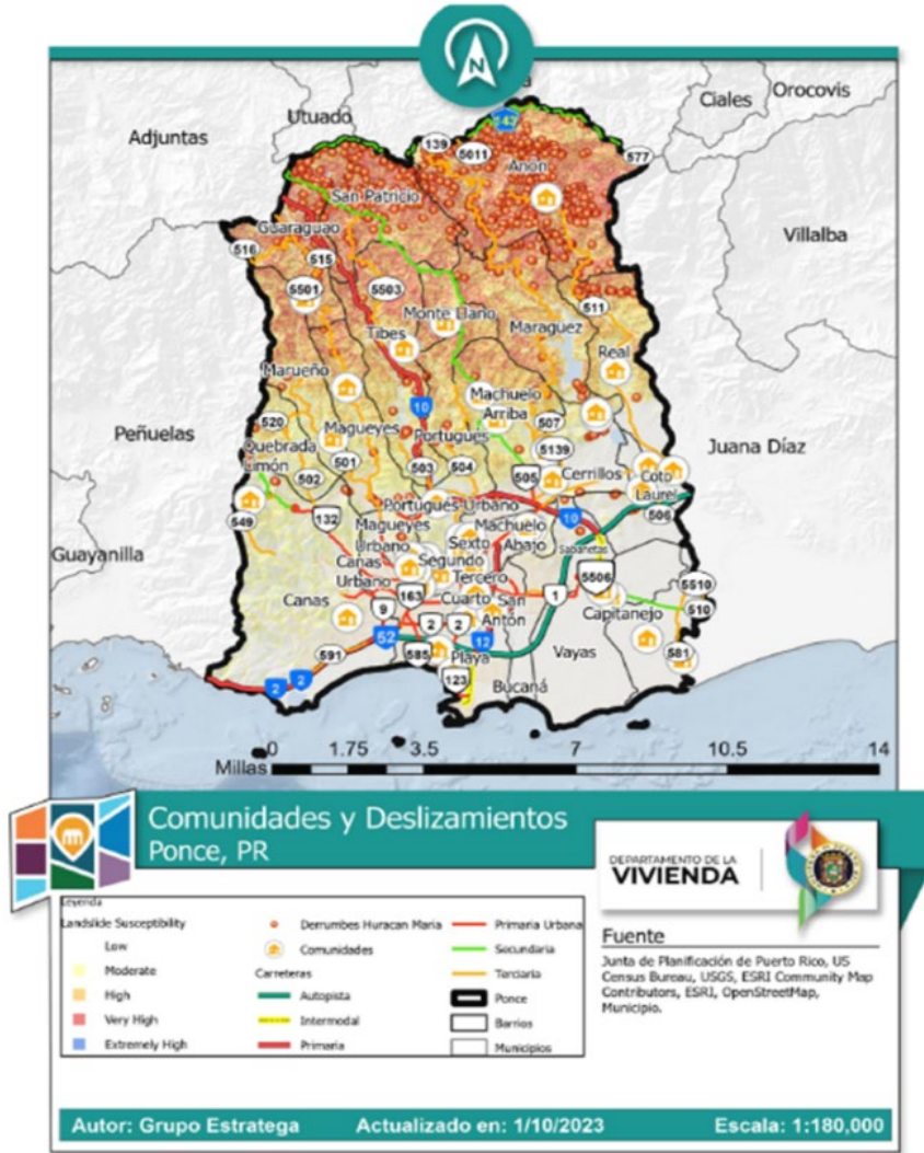
Figura 33: Deslizamientos de tierra en el Municipio de Ponce después del huracán María. Los puntos naranjas ilustran un grupo de desprendimientos concentrados en la parte septentrional y rural del municipio. Plan MRP, Municipio de Ponce.
