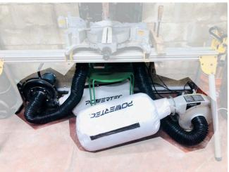
La localización de colector de polvo será en el área que ocupa el tablillero de la siguiente foto. El equipo tiene su propia base de soporte solo necesita atornillarse al piso para prevenir vibración y movimientos en la unión con el conducto. El equipo utiliza corriente 220v, tiene su propia rabiza y ya el espacio provee una toma de corriente certificada para el equipo.
