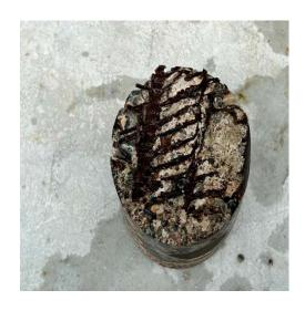
Losa del segundo nivel donde se muestra el nivel de corrosión de acero
