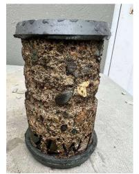
Núcleo de pared del primer nivel. Porosidad en la pasta y separación entre la pasta y el agregado
