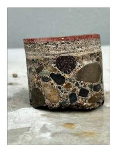
Núcleo de la losa de piso del segundo nivel sobre las tijerillas. Capa superior terminación intermedia mortero y en la parte inferior losa de hormigón.
