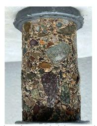
Núcleo de pared del segundo nivel. Porosidad en la pasta y separación entre pasta y agregado.
